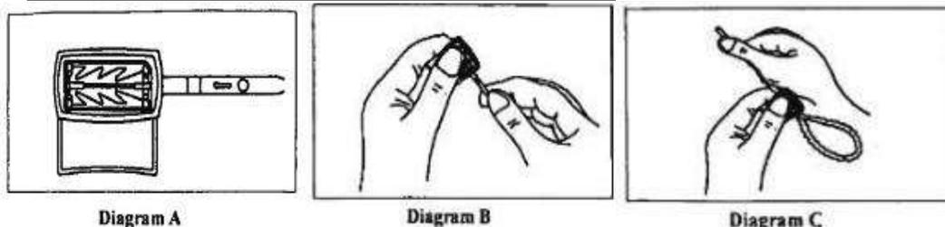
**Étape 1** Assurez-vous que le rabat d'étanchéité soit placé avec la face avant face à l'utilisateur comme indiqué dans le schéma A
